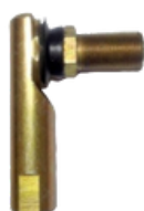
K - 8058 72209400 TERMINAL ROTULAR PINO M8x1,25 CARCAÇA M10x1,25 DIREITO COM COIFA BORRACHA
